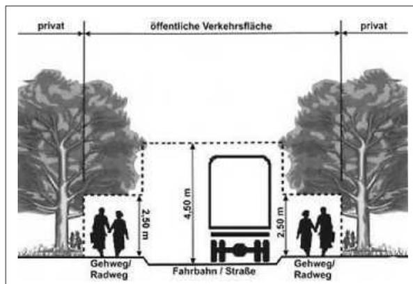
Bei Fahrbahnen ohne Gehwege ist ein seitlicher Sicherheitsraum von mindestens 0,75 m einzuhalten. Sofern ein Randstein vorhanden ist, kann der Sicherheitsabstand von der Fahrbahn auf 0,50 m reduziert werden.
